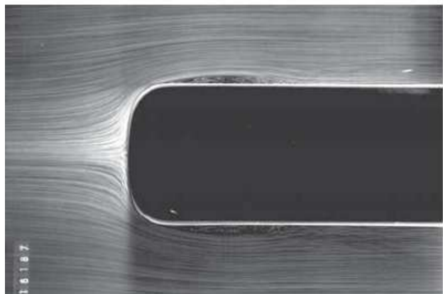
FIG. 12.15 – Décollement puis recollement dû à la transition vers la turbulence d’une couche limite autour d’un profil à nez presque plat (doc. ONERA).
