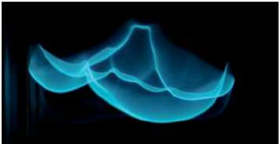
FIG. 10.30 – Instabilité de Darrieus-Landau d’un front de flamme prémélangée méthane-air, se propageant librement du haut vers le bas dans un tube de 14 cm de diamètre (doc. J. Quinard, G. Searby, B. Denel et J. Graña-Otero).
