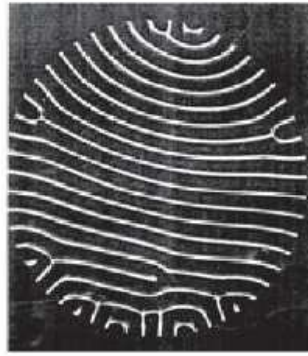
FIG. 11.7 – Système de rouleaux de convection d’une couche circulaire d’huile entre deux plaques maintenues à des températures différentes (vue de dessus). Les lignes blanches où la lumière est focalisée correspondent à celles des zones de séparation entre deux rouleaux où le fluide est ascendant. Les défauts et branchements du réseau de rouleaux sont dus aux conditions aux limites circulaires imposées, les rouleaux se raccordant préférentiellement à angle droit aux parois latérales (cliché V. Croquette, P. Legal et A. Pocheau).
