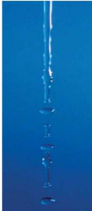
FIG. 8.19 – Déstabilisation par le mécanisme de Rayleigh-Plateau d’un jet liquide cylindrique tombant, suivie de la formation de gouttes (doc. J. Aristoff et J. Bush).
