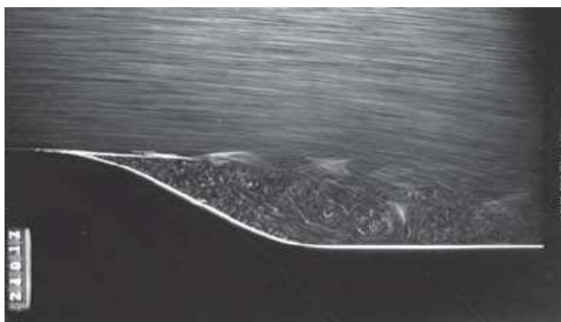
FIG. 10.10 – Profil de vitesse dans un diffuseur à pente élevée. On remarque l'existence d'une zone stagnante suivie d'une zone de recirculation (doc. H. Werlé, ONERA).
