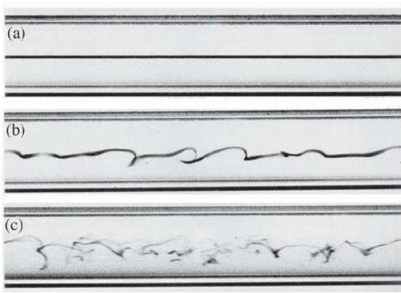
FIG. 2.8 – Reproduction de l'expérience historique de Reynolds ; visualisation dans un tube circulaire de colorant injecté ponctuellement à l'entrée de celui-ci dans un écoulement en (a) régime laminaire, (b) apparition de mouvements transverses du fluide, (c) régime turbulent (docs. N.H. Johannesen et C. Lowe, An Album of Fluid Motion ).
