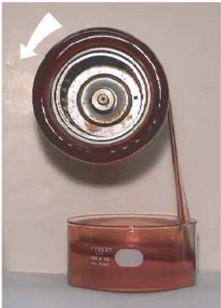
FIG. 4.17 – L’enroulement sur une bobine tournante du même fluide viscoélastique que sur la figure 4.16 met en évidence l’effet de sa viscosité élongationnelle élevée (doc. R. Welsh, J. Bico & G. McKinley).
