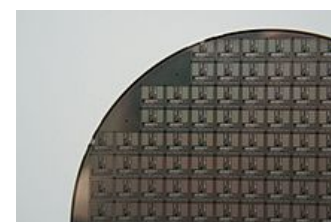
Illustration 10: microprocesseurs gravés sur une plaque de silicium.
