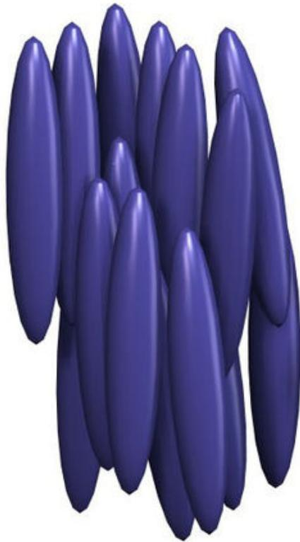
orientation des molécules dans un cristal liquide nématique
